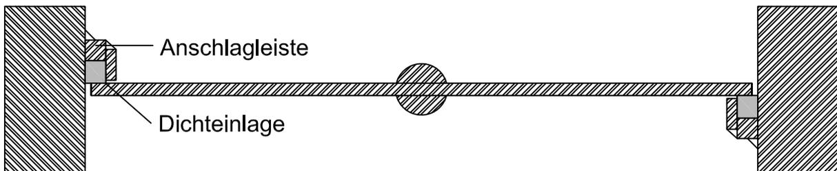
**Bauart: mit Anschlagleiste und Dichteinlage**
